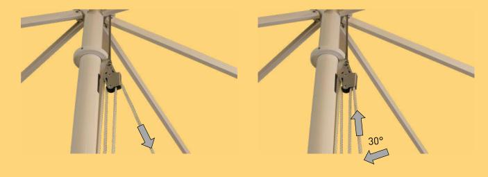
FILIUS mit Kurbel FK: Stecken Sie die Handkurbel in die Getriebebohrung und drehen Sie den Schirm, gegen den Uhrzeigersinn zu.
