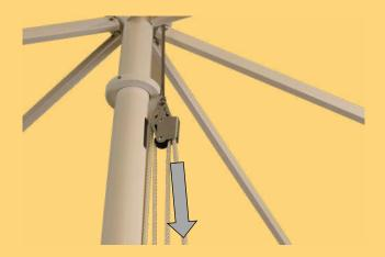
3. Schwenken Sie das Zugseil ca. 30° nach außen und verringern Sie Ihre Zugkraft. Das Seil verkeilt sich im oberen Flaschenzug und hält den Schirm so in geöffnetem Zustand.
